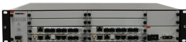
Рисунок 4. Внешний вид eNB (иллюстрация, конкретная модель может отличаться)
